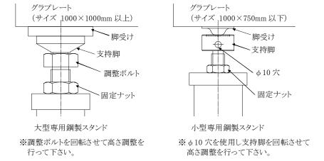
④ 使用面に水準器を置き、3 点の支持脚高さを調整しながら、グラプレート使用面の水平出しを行います。 完了後、固定ナットを締め付けて下さい。補助足のあるグラプレートについては、水平出しのあと補助足 をグラプレート下面に軽く当てて下さい。強く当てると使用面精度に影響しますのでご注意下さい。
