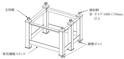
② グラプレートを専用鋼製スタンドの上にクレーンなどを使って設置します。
